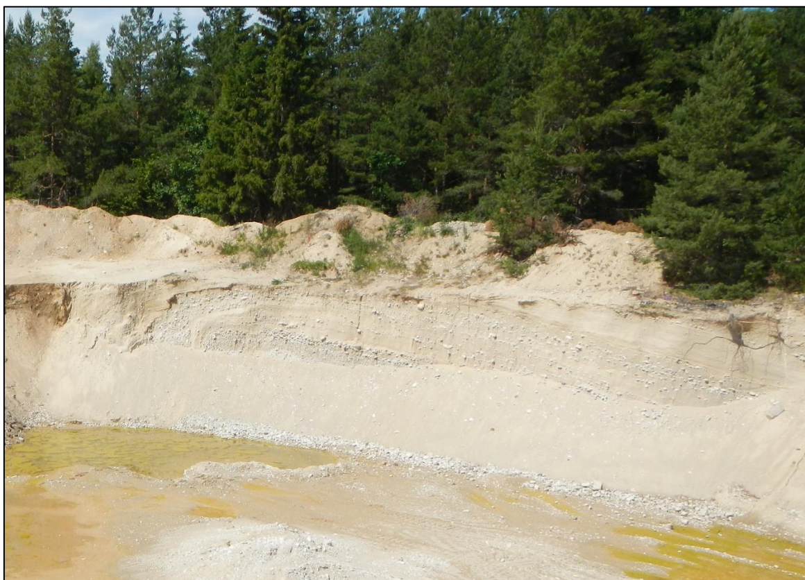
Foto 1. Liivade-kruusade vaheldumine Jaakna III kruusakarjääri seinas, kaevandi K-8 lähistel. Sein kõrgus on ca 5-6 m (2017. a).
